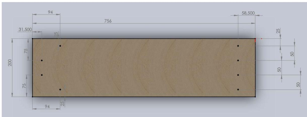
Visser la plaque aux supports avant et arrière avec les trous extrêmes (ceux marqué sur la vue d'ensemble). Les trous restant sont destinés à recevoir d'autres renforts.
