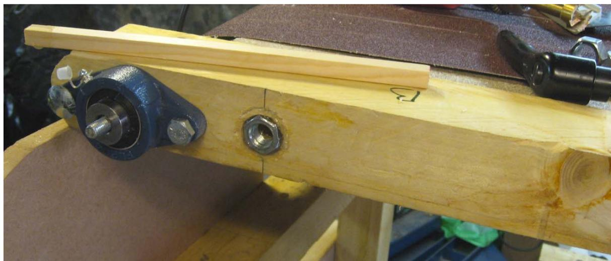
Placer ensuite le convoyeur sur l'ossature, en le faisant reposer sur le bloc de réglage de hauteur puis fixer les quatre tiges.
